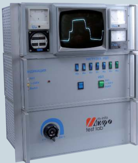
Значительное изменение напряжения в сети влечет за собой переход ИБП на работу от собственных батарей. При этом сетевая синусоида принимает вид практически прямоугольной волны
